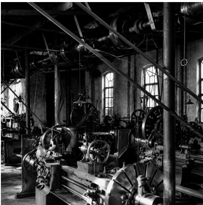
À titre d'exemple, un arbre de transmission auquel les machines sont couplées par des courroies plate.
